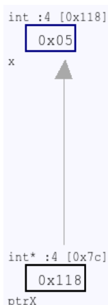
Figura 2: Diagramador mostrando una variable señalada por un puntero.
