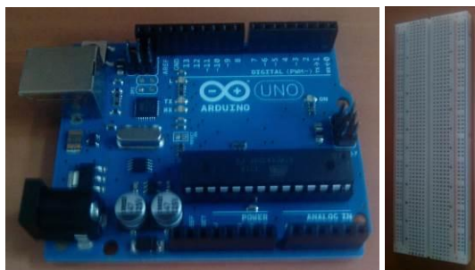
Figura 1. PCB de Arduino y placa de prototipado
